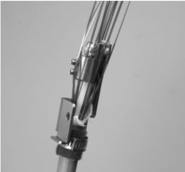
4.7.8 Fixera kabeln med slangklämman. (Spänn ej åt för hårt.)
