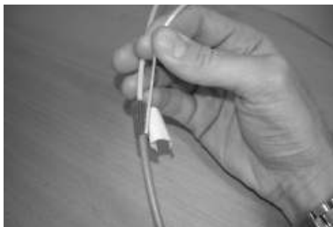
4.10.6 Vik tillbaka kevlarret över filtappen och lås åter kevlarret med filtappen genom att linda ett varv runt kabeln.
