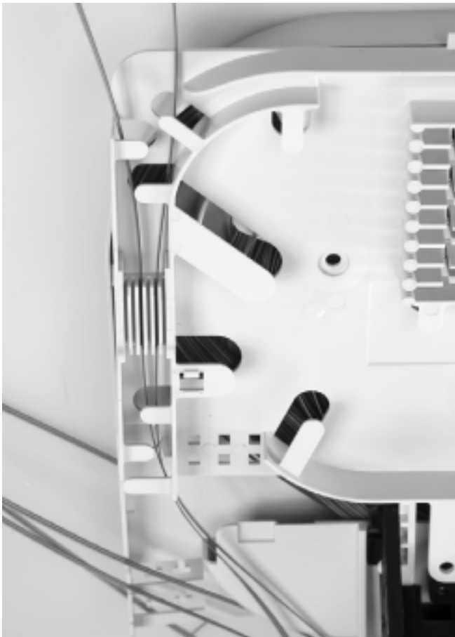
4.6.3 Montera fiberbanden stående färgrikt i spårerna och led fram dem till skarvområdet. Två band kan placeras i varje spår. Under preparering kan banden löpa rakt genom kassetten som är öppen i hörnet, se bild.
