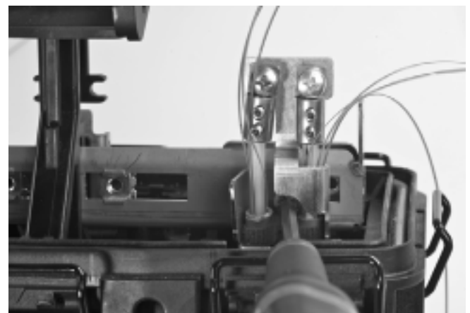
4.8.10 Spänn åter skruven och skruva fast dragavlastningsdonet i det stora metallbeslaget. Se till att fiberbanden löper så fritt som möjligt och utan påverkan av vridningar el dyl. Se bild.
