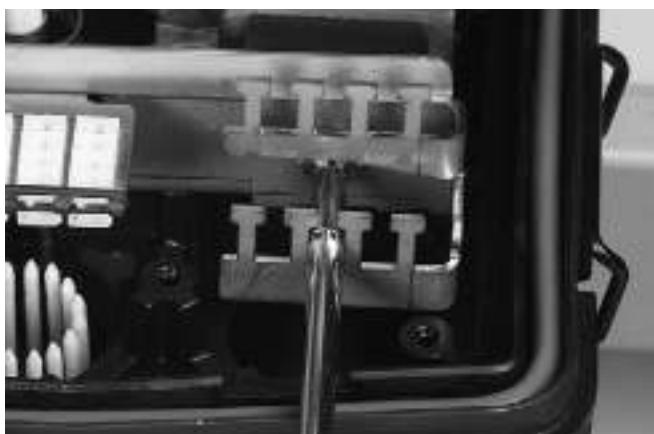
4.10.3 Montera dragavlastningsbeslaget i U-profilens korgmutter. Fixera beslaget med skruven så att kablarna kan löpa rakt i förhållande till kabelgenomföringen.
