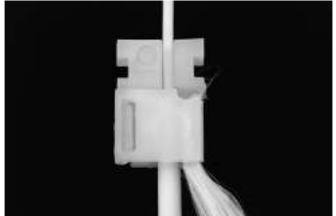
4.11.8 Stäng locket och se till att det låser. Klipp bort överskottskevlar.
