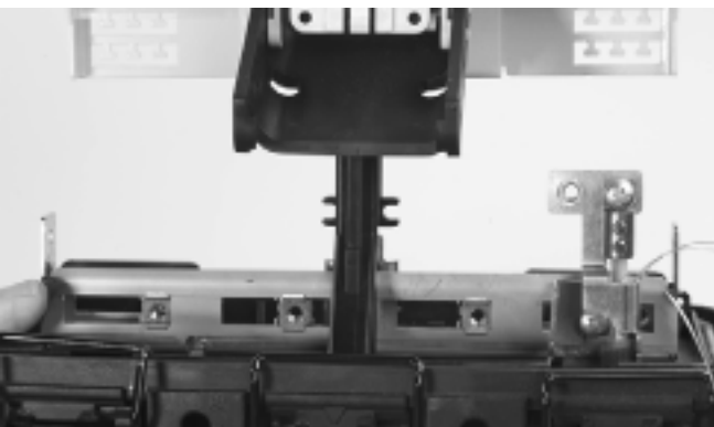
4.8.7 Metallbeslaget monteras i korgmutter i skarvboxen. Se till att fiberbanden löper så fritt som möjligt och utan påverkan av vridningar el dyl. Se bild.
