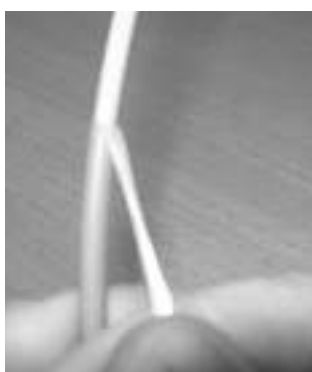
4.10.5 Spänn kevlarret bakåt, längs kabelmanteln. Klipp en bit filttape L = 35 mm. Samla ihop kevlarret. Linda filttape så att kevlarret låses fast.
