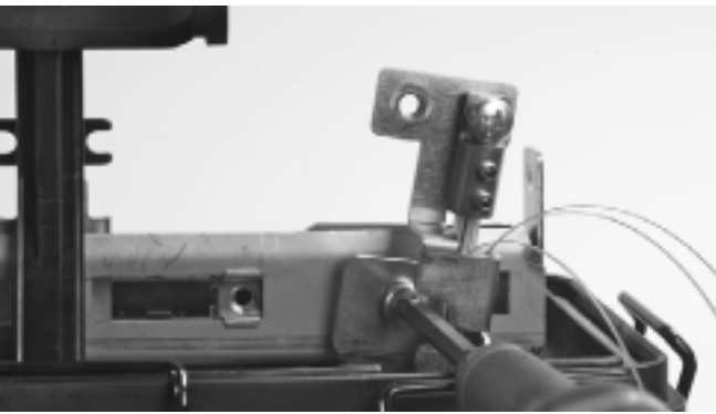
4.8.6 Kabeln backas tillbaks till metallbeslaget med skruven i. Se bilden.
