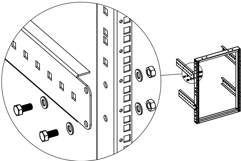
Montera inre konsolen på långsidan med 2 bultar(M8 x 16), 4 brickor(8,4 x 16x 1,6) och 2 muttrar(M8).
