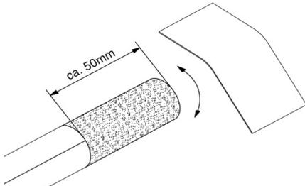
1) Das speedpipe von Verschmutzungen und Gleitmittelrückständen säubern. Um dies zu gewährleisten, beide speedpipe-Enden ca. 50mm mit Schmirgelleinen Körnung 240 radial anrauen.
