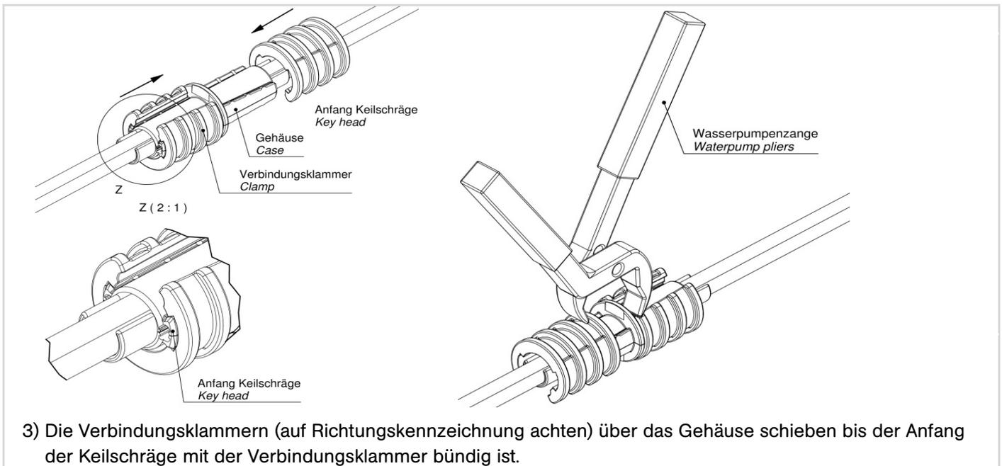
3) Die Verbindungsklammern (auf Richtungskennzeichnung achten) über das Gehäuse schieben bis der Anfang der Keilschräge mit der Verbindungsklammer bündig ist.
