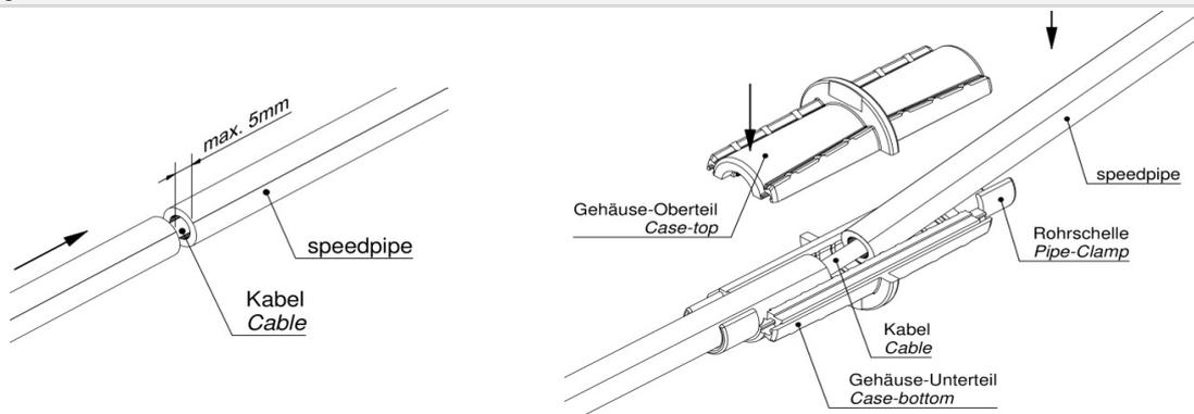
2) Beide speedpipe-Enden mittig in das Gehäuse-Unterteil legen. Durch die beiden angeformten Rohrschellen des Gehäuse-Unterteils sind die Enden fixiert. Gehäuse-Oberteil aufsetzen.
