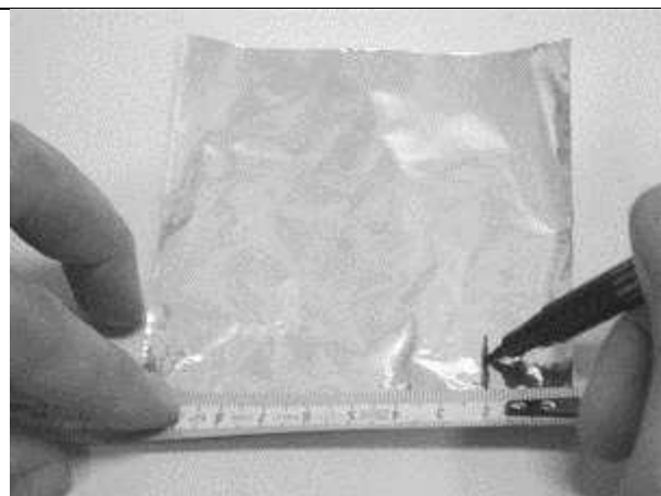
Segnare la protezione d'alluminio a 20 mm dal bordo.
